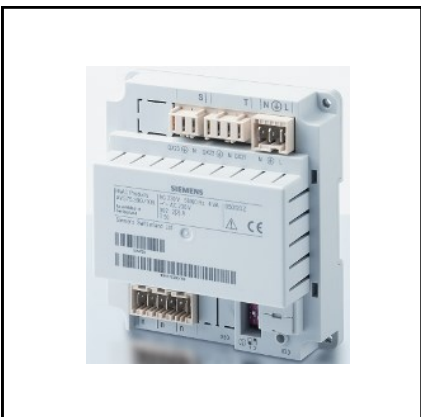
Przystawka AVS75 Zestaw zawiera przystawkę AVS75 wraz z kablem komunikacyjnym do modułu sterowania kotłem LMS14. Do jednego kotła można podłączyć maksymalnie trzy moduły AVS75 (moduł 1 i 2 do sterowania strefą grzewczą, a moduł 3 do innych funkcji).
